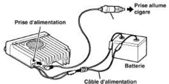
**Si vous désirez une coupure par le contact**, utilisez le câble optionnel EDC37 ou EDC43 (câble allume cigare). Le câble EDC 36 est aussi compatible. Connectez un de ces câbles entre la borne ACC ou la prise allume cigare du véhicule et la prise d'alimentation externe du DR135. (note : dans certains véhicules la prise allume cigare n'est jamais coupée). Si vous utilisez cette option, vous pouvez couper l'alimentation du DR 135 par le contact.
