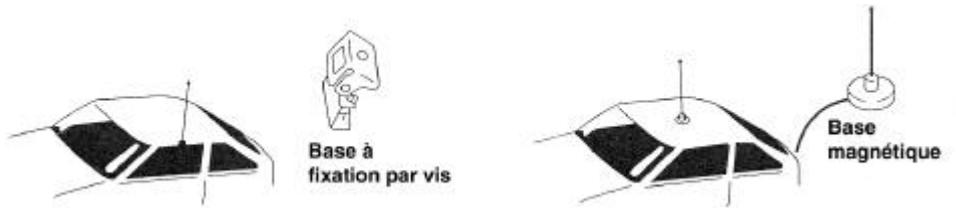
Utilisez un câble 50 ohms pour connecter l'antenne. Les antennes mobiles nécessitent une base de montage adéquate pour leur bon fonctionnement. Pour plus d'information, voyez la documentation de l'antenne.
