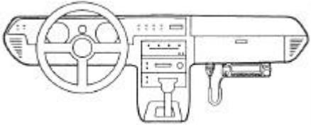
Le transmetteur peut être placé à n'importe quel endroit dans le véhicule où le micro et les commandes sont accessibles sans pour autant gêner la conduite. Si votre véhicule est équipé de l'airbag, vérifiez que l'installation ne gêne pas leur fonctionnement. Si vous n'êtes pas sûr, contactez votre garagiste.
