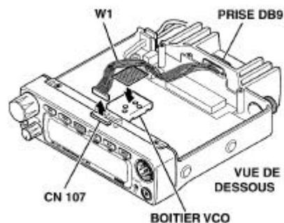
3. Placez le collant double face sur le boîtier contenant le VCO (boîtier métallique sur le circuit).
